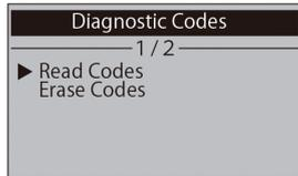
①Read Codes を選択し、ENTER キーを押すと故障コードの読み取りを開始します。
