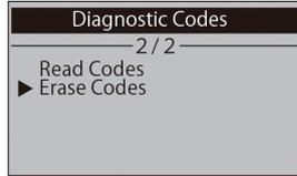
①Erase Codes を選択し、ENTER キーを押すと故障コードの読み取りを開始します。
