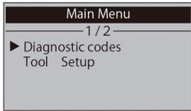
①液晶画面のカーソルが Diagnostic codes を選択していることを確認して ENTER キーを押してください。
