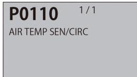
②故障箇所 P コードが画面に表示されます。(左画面は P0110 AIR TEMPESEN/CIRC のエラーコードの表示例)
